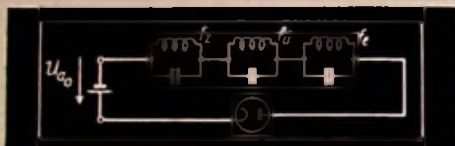
Abb. 1. Prinzipschaltung der Eintaktmischung mit Diode
